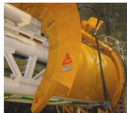
Spritzroboter im L2-Bereich
