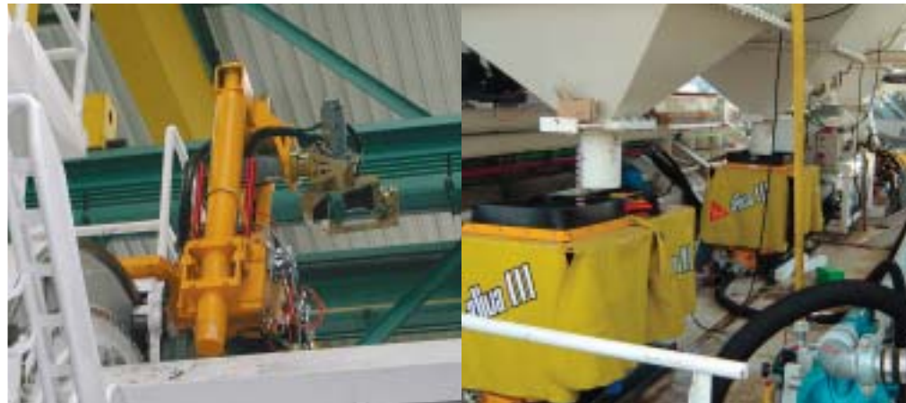
Temporärer Spritzroboter mit 800 mm Teleskopierung, auf Drehkranz von Bohrlafette montiert
