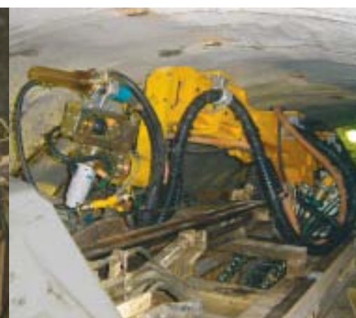
Roboter mit dreifach teleskopierbarem Spritzarm
